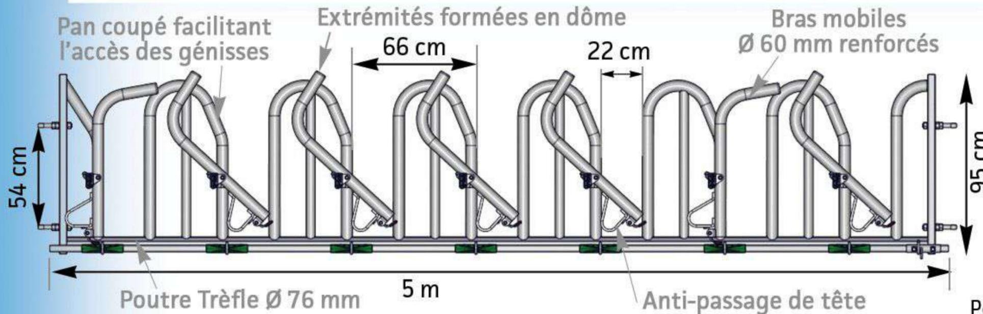
Cornadis automatique avec verrouillage par le bas. Construit en tube de 60mm soudé sur une poutre Trèfle Ø76mm, il est réservé aux animaux très encornés. Les festons et le bras mobile en tube Ø60mm sont dimensionnés pour laisser ruminer sans contrainte.
