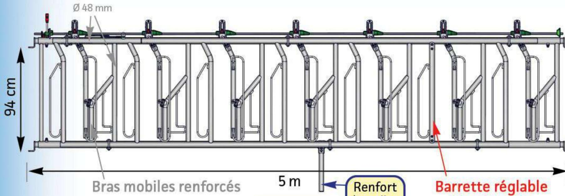
Le Cornadis RC II est dérivé du cornadis Axial II. Il est équipé d'un double cadre et d'une poignée escamotable qui permet un réglage collectif minutieux des encolures.
