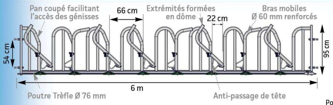
Cornadis automatique avec verrouillage par le bas. Construit en tube de 60mm soudé sur une poutre Trèfle Ø76mm, il est réservé aux animaux très encornés.
