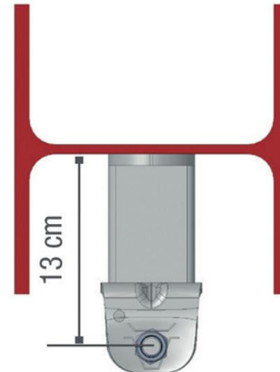
Paire de chapes rallongées multifix se fixant à l'intérieur d'un poteau en H et permettant de monter une barrière déportée de 13cm du poteau.
