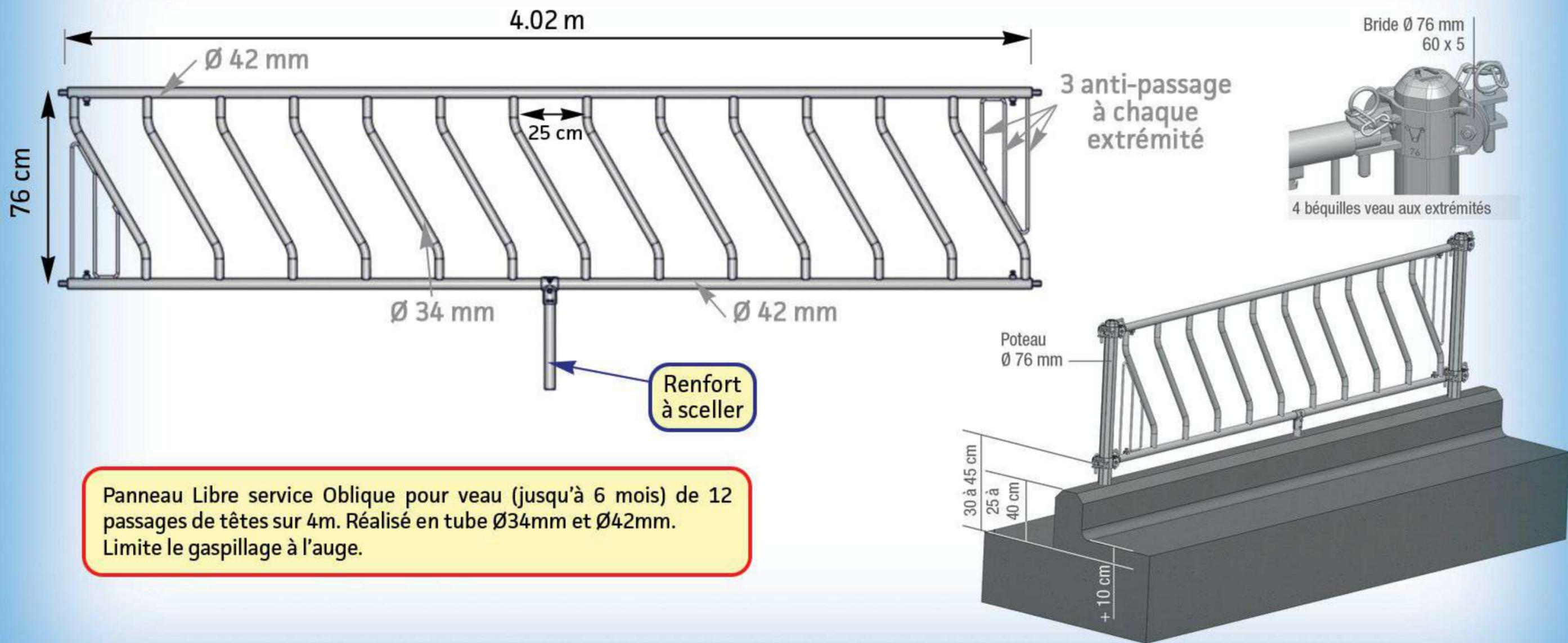
Panneau Libre service Oblique pour veau (jusqu'à 6 mois) de 12 passages de têtes sur 4m. Réalisé en tube  $\varnothing 34$ mm et  $\varnothing 42$ mm. Limite le gaspillage à l'auge.
