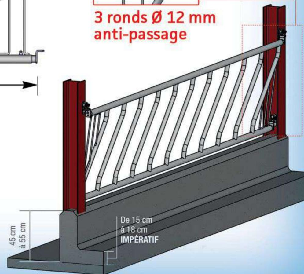
Panneau libre service oblique de 8 places sur 4m, évitant le gaspillage. Fourni avec 4 embouts de réglage. Ne convient pas à l'engraissement et aux taurillons.
