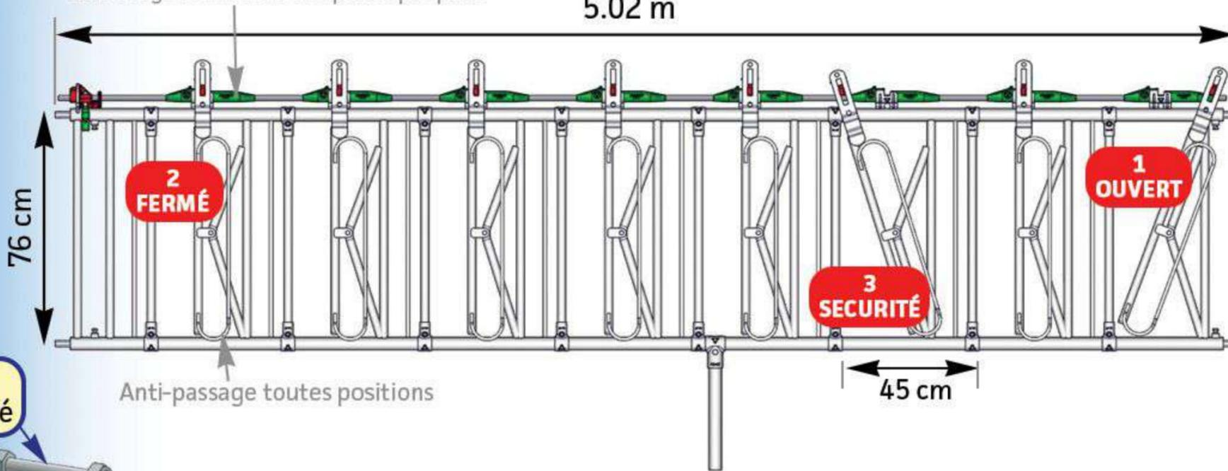
Panneau SAFETY veau avec encolures réglables, 4 béquilles de réglage et, en option, un porte-seaux rabattable.
