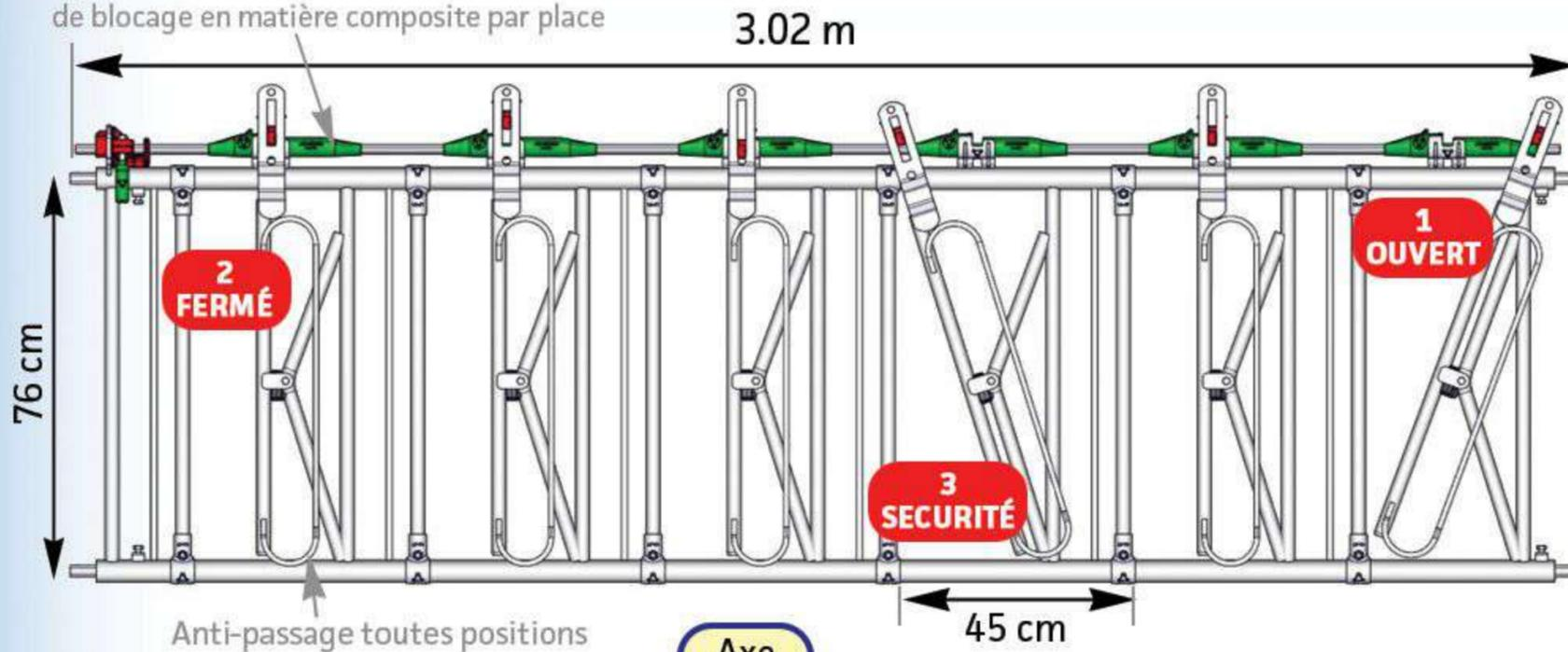
Panneau SAFETY veau avec encolures réglables, 4 béquilles de réglage et, en option, un porte-seaux rabattable.
